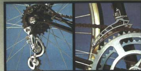
1 - New Huret Jubilee rear Derailleur mechanism
