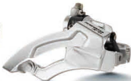
X.9 Front Derailleur Low Mount • 154 grams
