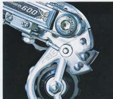
Hatch-Plate Mechanism (Shimano-600EX Rear Derailleur)
