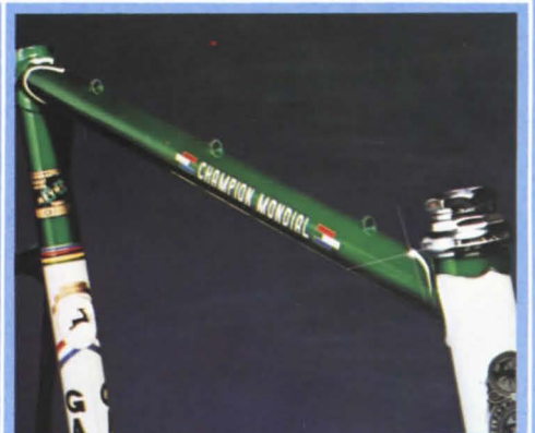
Drei Bremskabelführungen auf Oberrohr.
