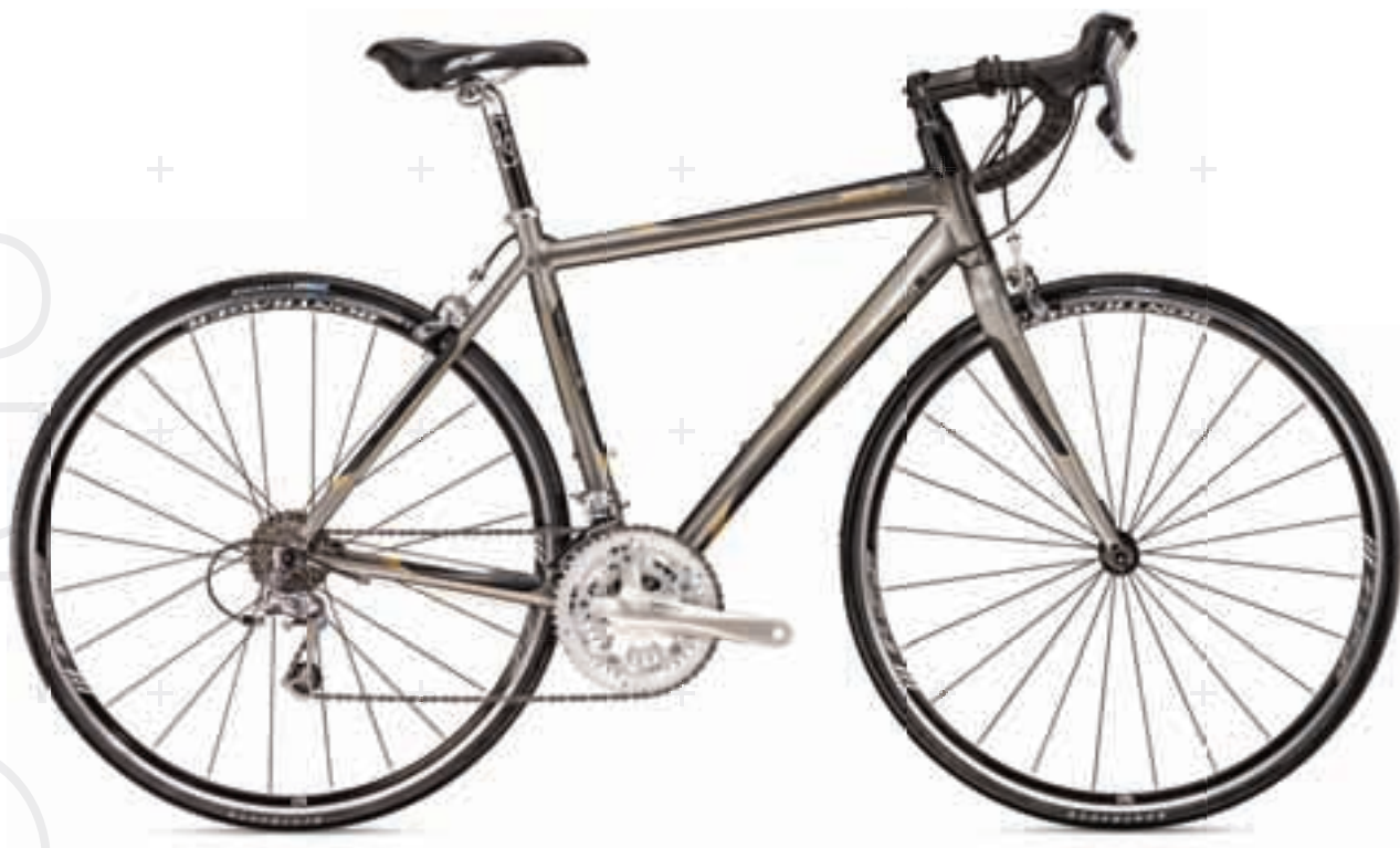
PILOT 2.1 WSD™ // FRAME Alpha Black Aluminum // FORK Bontrager Satellite Plus, carbon // WHEELS Bontrager SSR CRANK Shimano R-553 50/39/30 // REAR DERAILLEUR Shimano 105 // COLOR Dark Charcoal / Chocolate
