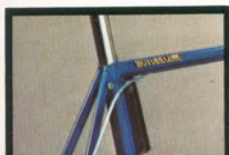
Barillet de serrage de la tige de selle intégré aux haubans profilés.
