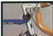
Jeu de direction THUN avec écrou monobloc autofreinant. Potence en alliage léger.
