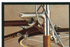
Jeu de direction MOTOBECANE et potence en alliage léger type aéro.
