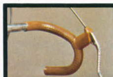
Guidon dural avec gainage MOTOBECANE. Leviers course perforés, en alliage léger.
